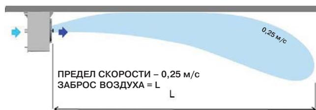
Заявленные величины, данные в таблице, базируются на температуре воздуха 20 °C под плоским потолком без каких-либо препятствий. Высота и воздушная циркуляция в помещении могут влиять на заброс воздуха. Заявленные расстояния основаны на конечной скорости воздуха 0,25 м/с.
