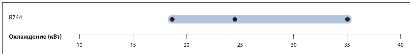
Условия: EN12900 R744: кипение -10°C, выход охладителя газа: 35°C/90 бар, перегрев: 10K
