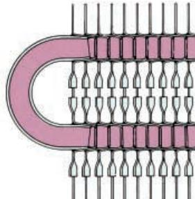
Tube du fluide réfrigérant de forme ronde. Pour ces condenseurs il est possible de fournir, sur demande exprès du client, un diffuseur en plastique type **C**.
