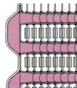
Tube du fluide réfrigérant de forme ovale. Structure très compacte avec un rapport élevé puissance/volume. Pour ces condenseurs il est possible de fournir, sur demande exprès du client, un diffuseur en plastique type **CF**.
