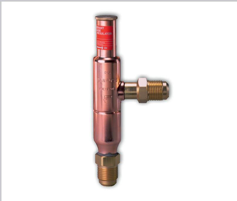
KVC – это регулятор производительности, который применяется для согласования производительности компрессора с фактической нагрузкой на испаритель. Регуляторы KVC устанавливаются в байпасную линию между сторонами низкого и высокого давления системы охлаждения, обеспечивая более низкий предел давления всасывания на входе в компрессор путем замещения производительности подачей горячего/холодного газа из зоны высокого давления в зону низкого давления.
