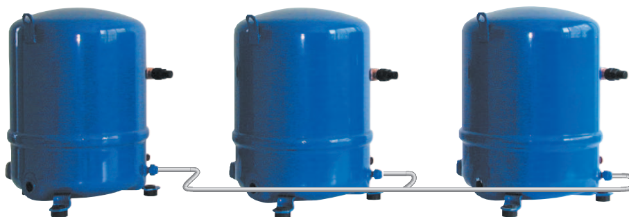
Рис. 2.1 Пример правильно собранной линии выравнивания уровня масла. Обратите внимание, что все компрессоры имеют одинаковый размер (одинаковую производительность) и установлены на одном уровне.
