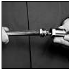
Übergangskupplung bis zum Anschlagpunkt in das geeignete Innengewinde einschrauben und handfest anziehen.
