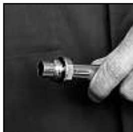
Übergangskupplung auf Sauberkeit und korrekten Sitz der Dichtelemente überprüfen. ▷B◁Oyster auf das Rohr schieben. Dabei kein Öl- oder Gleitmittel verwenden.
