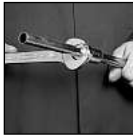
Übergangskupplung mit Gabelschlüssel fest anziehen.
