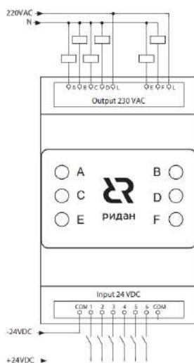
Рис. 2 Схема подключения модуля Р-РМ
