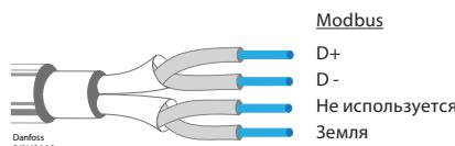
Подробную информацию по настройке Modbus и установленных параметрах программного обеспечения см. в техническом описании контроллера перегрева EKE и Modbus RTU RS485 для передачи данных EKD EIM.
