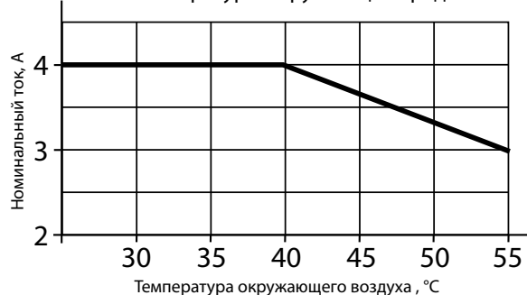
График зависимости максимального тока от температуры окружающей среды
